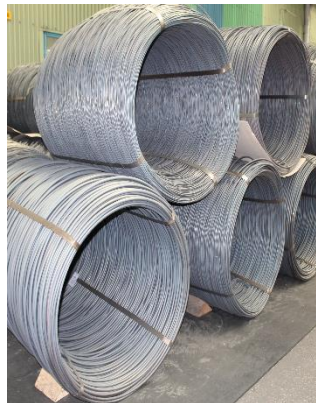
완제품 용도에 따라 탄소강, 크롬강, 베어링강 등 다양한 선재(Wire Rod) 제작
